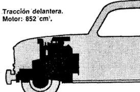
Tracción delantera. Motor: 852 cm<sup>3</sup>.
